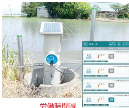
設定された水位になるように、自動で給水します。タブレット端末などで、水田ごとの水位や水温が確認できます。
